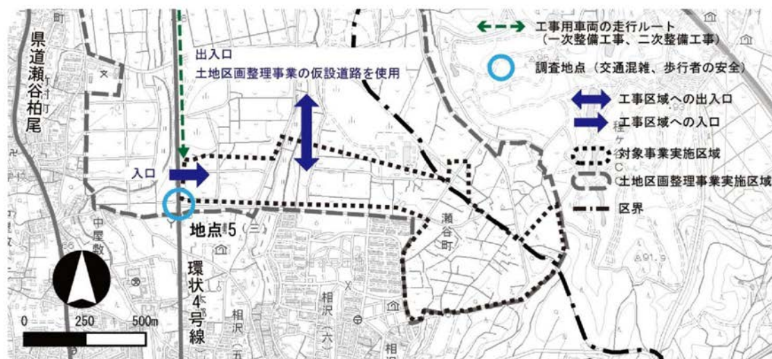
図 9-1 一次整備工事時の工事用車両の工事区域の出入口
